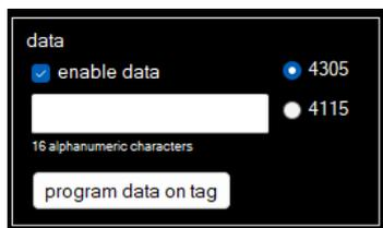
Das Kontrollkästchen „enable data“ schaltet die Datenanzeigefunktionen von ARE H3.0 ein, um Daten in der zweiten Zeile des Displays anzuzeigen. Es werden nur gültige Daten mit korrekter Prüfsumme angezeigt.
